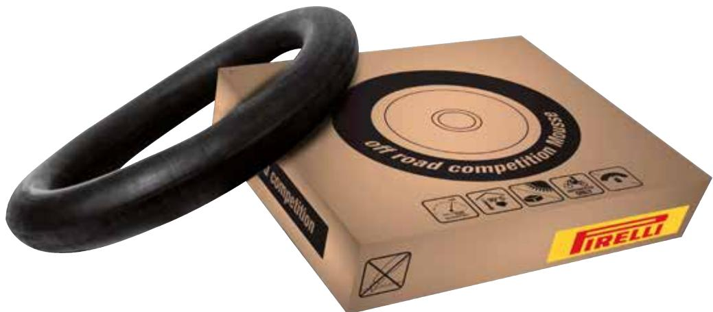
Un mousse es un elemento 3-D circular hecho con particulares celdas de esponja para reemplazar cámaras convencionales en los neumáticos de off-road; técnicamente es un anillo de esponja butyl honeycomb con celdas llenadas de gas para simular una presión de 0.7 bar. Gracias a su estructura, un mousse consigue una máxima resistencia en condiciones extremas de off-road.
