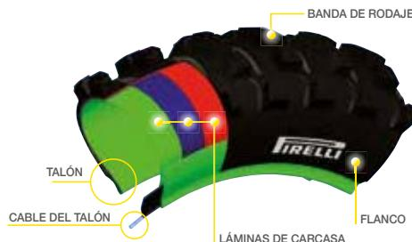
También llamados neumáticos convencionales o "x-ply". Dependiendo de las diferentes especificaciones en cuanto a velocidad y carga, la carcasa del neumático se estructura usando dos o más capas solapadas. Cada capa está hecha de cordones textiles recubiertos de goma y el ángulo de solapamiento está pensado para que el neumático se acomode a las características dinámicas necesarias.
