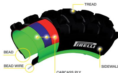
On les appelle également pneus conventionnels ou x-ply. Selon les spécificités de vitesse et de charge, la carcasse du pneu est composée de deux ou plusieurs couches superposées. Chaque couche se compose de fils de tissu revêtus de caoutchouc et l'angle de superposition est conçu pour donner au pneu les caractéristiques dynamiques requises.
