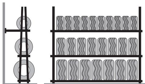
La meilleure méthode pour le stockage est verticalement dans les rangées d'un pneu haut, sur des supports, placés à au moins 10 cm du niveau du sol, avec les parois latérales positionnées verticalement, de sorte que le profil ne soit pas modifié (fig.1).
