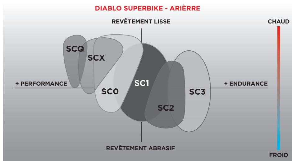
**Note:** Les informations de température se réfèrent aux conditions d'utilisation du pneu. Le choix du composé peut varier en fonction du réglage de la moto et du style de pilotage. Veuillez consulter votre revendeur ou le service racing.
