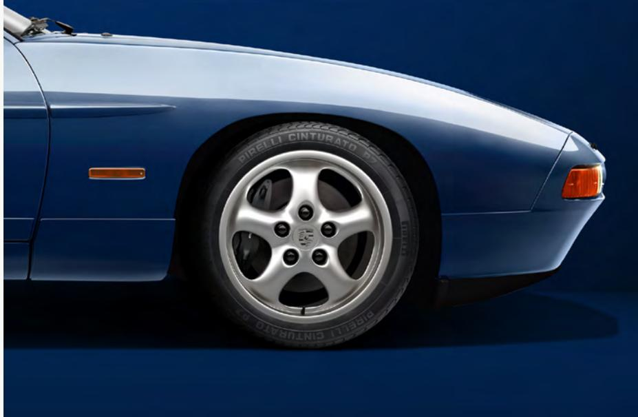
In fase di costruzione della 928, prodotta in serie a partire dall'anno modello 1978, venne dato un ruolo di primo piano alla struttura leggera. A questo scopo le porte, i parafanghi anteriori e il cofano motore vennero prodotti in alluminio invece che in lamiera di acciaio. Dietro i paraurti in plastica integrati nella carrozzeria erano presenti inoltre profili in alluminio, in grado di resistere a un impatto fino a 8 km/h senza danni.
